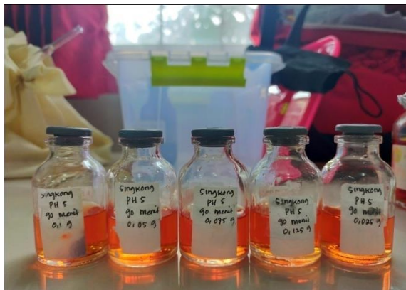
Larutan Kulit singkong yang ditambahkan buffer pH 5 dan Alizarin sulfonat
