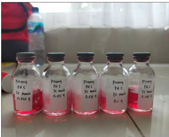
Larutan Kulit pinang yang ditambahkan buffer pH 5 dan alizarin sulfonat
