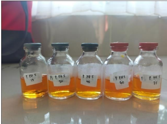
Larutan Kulit pinang setelah ditambahkan buffer pH 5 dan Alizarin sulfonat
