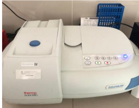
Pengukuran panjang gelombang dan kurva kalibrasi menggunakan alat spektrofotometer
